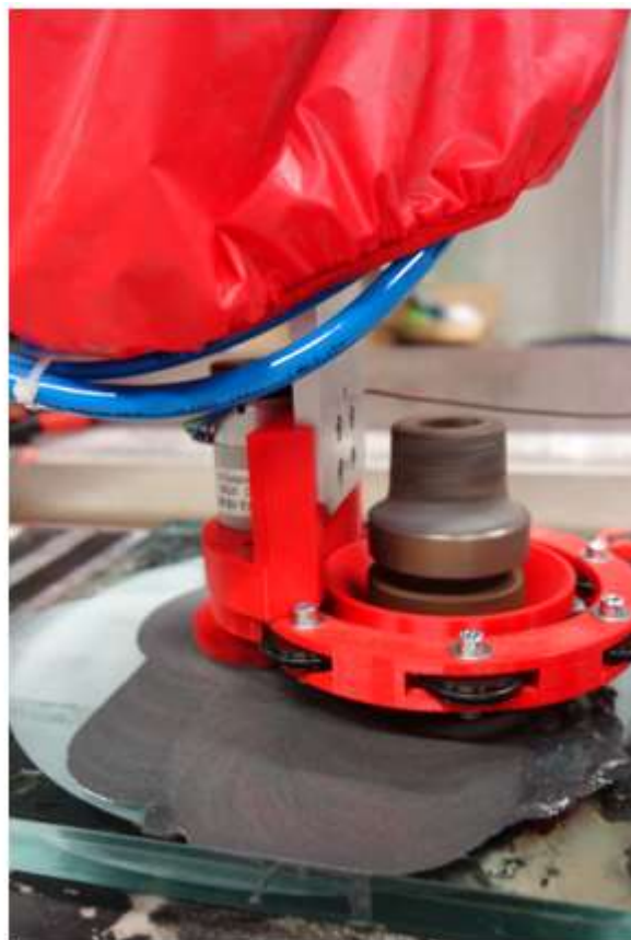
Obr. 4 Robotické rameno KUKA na pracovišti TUL v rámci testování různých nástrojů.
