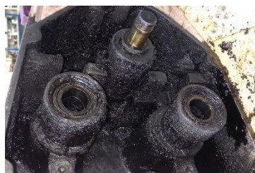
Obr. 4 Vnútorný priestor vrchnej časti pracovnej stanice s produktami degradácie oleja Dacta SYNT 220
