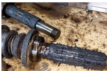
Obr. 5 Detail komponentov pracovnej stanice s produktami degradácie oleja Dacta SYNT 220
