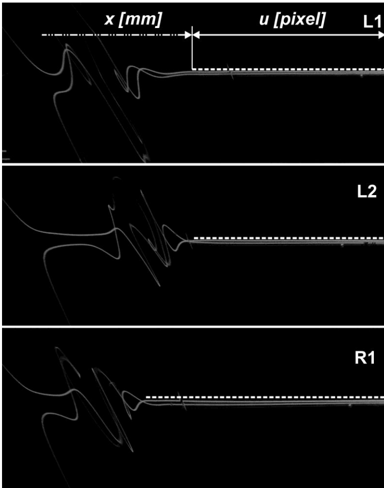
Obr. 4 Odražené křivky spolu s detekcí počátku deformace pro vzorky L1, L2, R1
